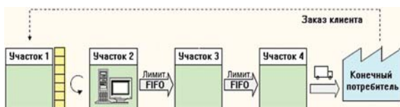
Рис. 1. Структура метода лимитированных очередей FIFO.
