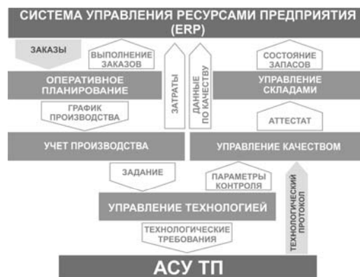
Рис. 1. Функциональная схема АСУП
